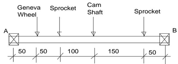
Fig.3.1 Feeder Shaft Loading
