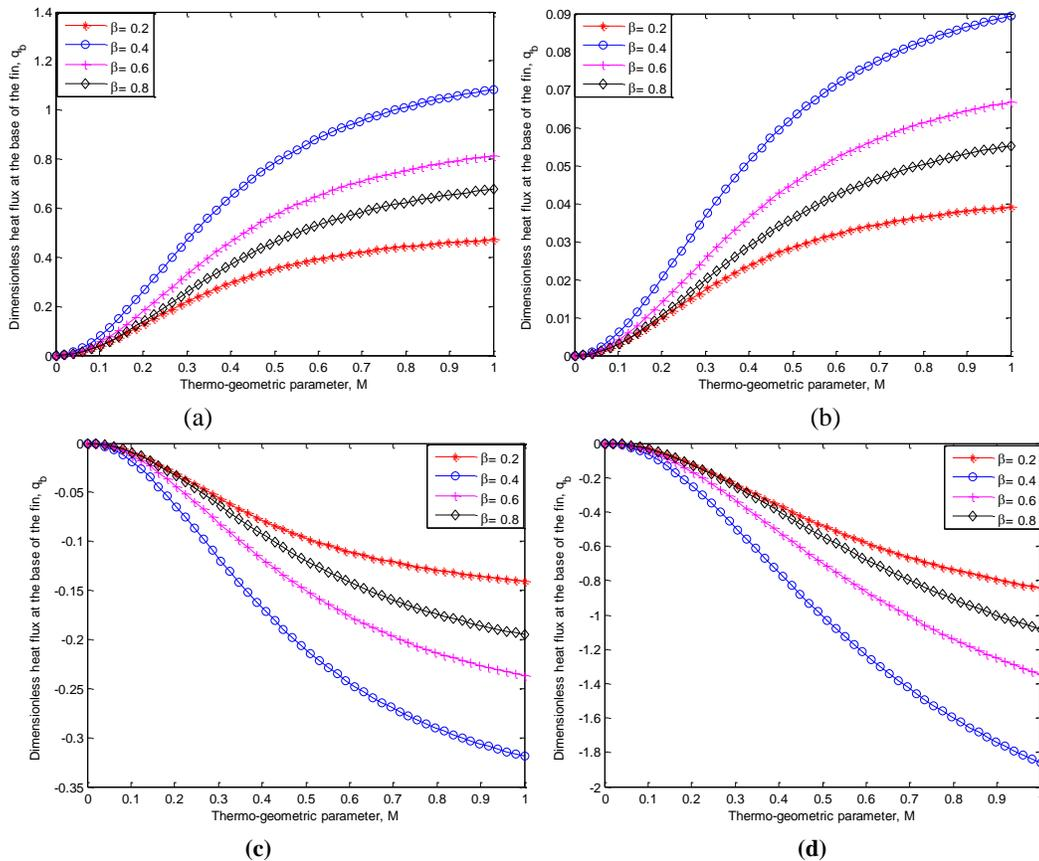
Fig. 3. Effects of thermal conductivity parameter of the fin when (a)  $Q=0.4, \gamma=0.2, \beta=0.8$  (b)  $Q=0.8, \gamma=0.2, \beta=0.8$  (c)  $Q=0.8, \gamma=0.4, \beta=0.8$  (d)  $Q=0.8, \gamma=0.8, \beta=0.8$
