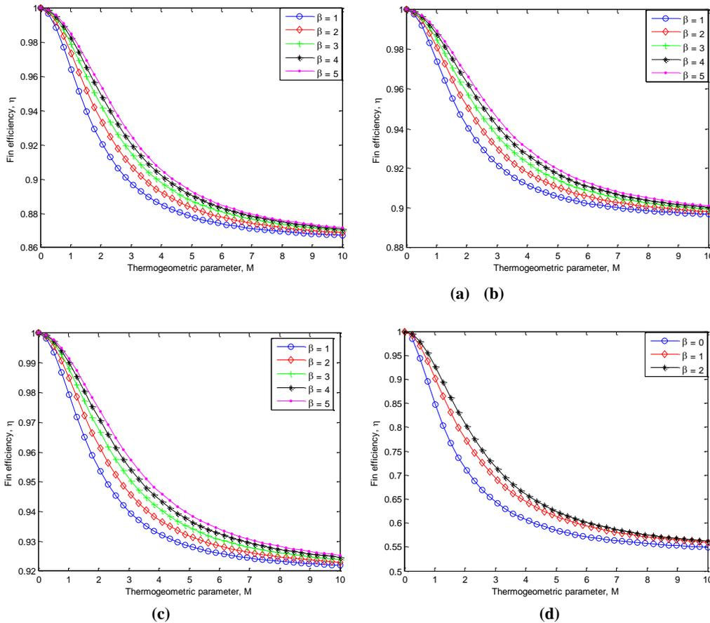
Fig. 5. Effects of thermal conductivity parameter on the efficiency of the fin when (a)  $n=0, Q=0.6, \gamma=0.2$  (b)  $n=0, Q=0.5, \gamma=0.6$  (c)  $n=0, Q=0.6, \gamma=0.4$  (d)  $n=0, Q=0.2, \gamma=0.2$
