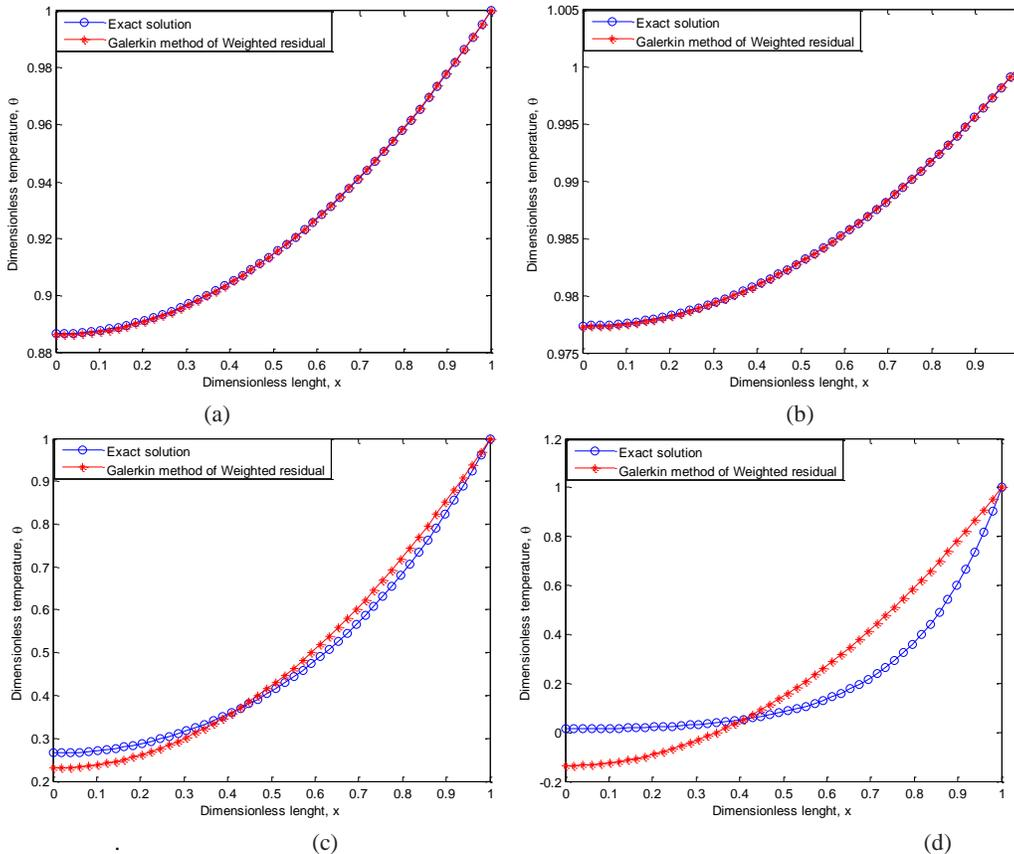
Fig. 6. Dimensionless temperature distribution in the fin when (a)  $n=0, M=0.5, \beta=0, Q=0$  (b)  $n=0, M=0.5, \beta=0, Q=0.8$  (c)  $n=0, M=2, \beta=0, Q=0$  (d)  $n=0, M=5, \beta=0, Q=0$
